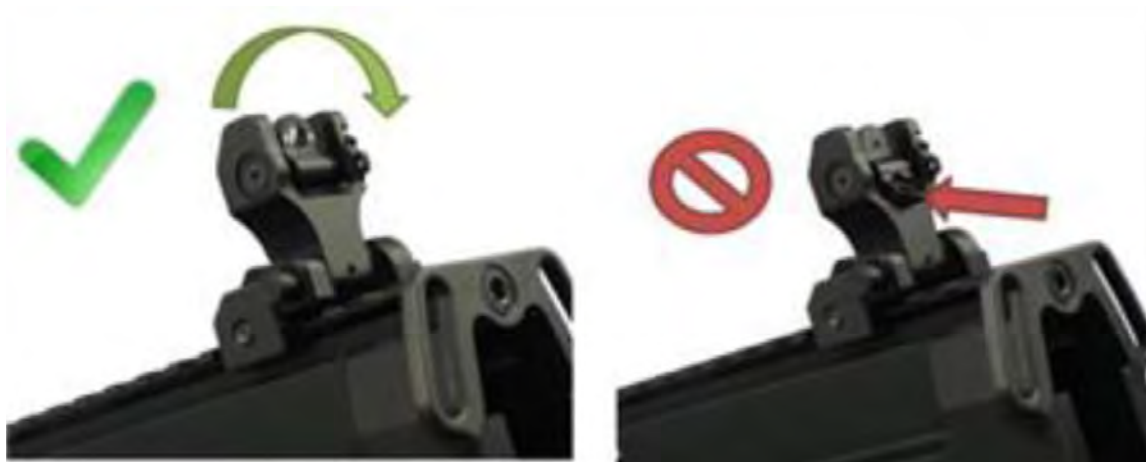
Рисунок 7.2 – Встановлення діоптрію для більшого отвору.
