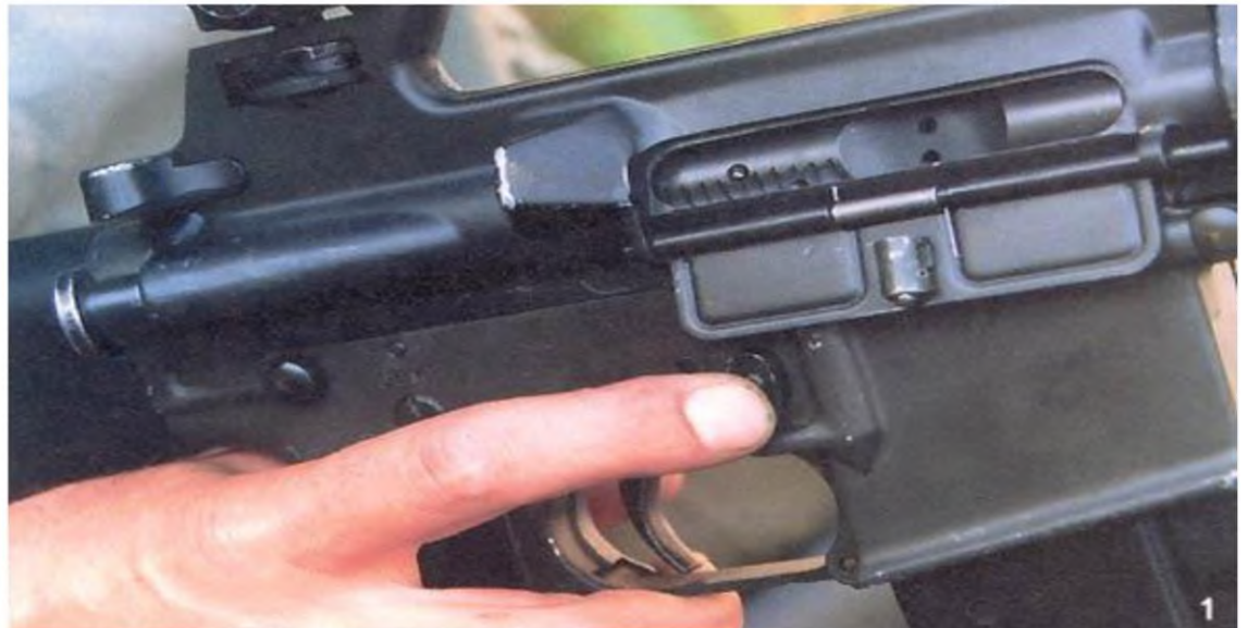
Рисунок 1.10 – Натискання вказівним пальцем на кнопку застібки магазину
