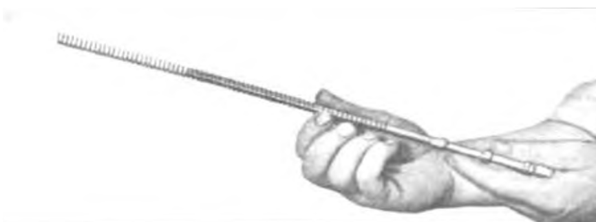
Рисунок. 5.26 – Відокремлення пружини поршня від штока поршня
