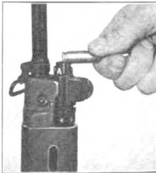
Рисунок. 5.24 – Зняття газової пробки за допомогою патрона
