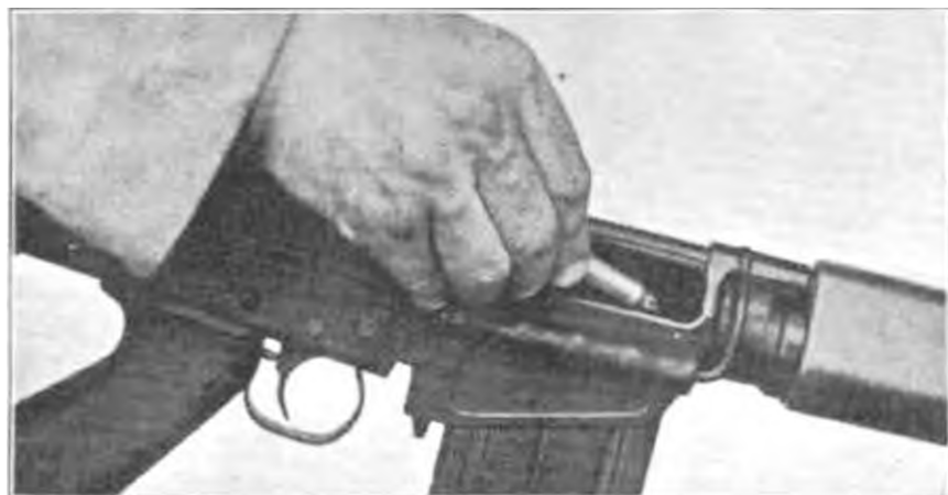
Рисунок. 5.14 – Досилання гранатного патрона в патронник
