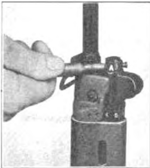
Рисунок. 5.23 – Зняття газової пробки за допомогою патрона
