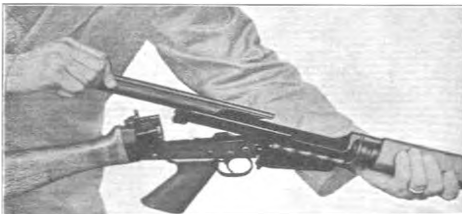
Рисунок. 5.19 – Зняття кришки ствольної коробки
