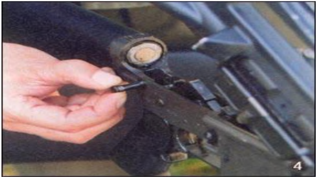
Рисунок 1.13 – Виштовхнути чеку в задній частині спускової коробки та відкинути вгору задню частину ствольної коробки
