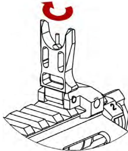
Рисунок 2.49 – Регулювання мушки (вкручування)
