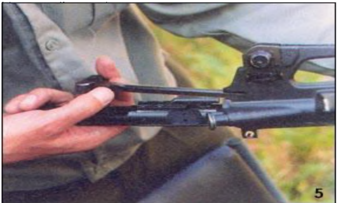
Рисунок 1.14 – Вилучення стебла затвора та планки перезарядження.
