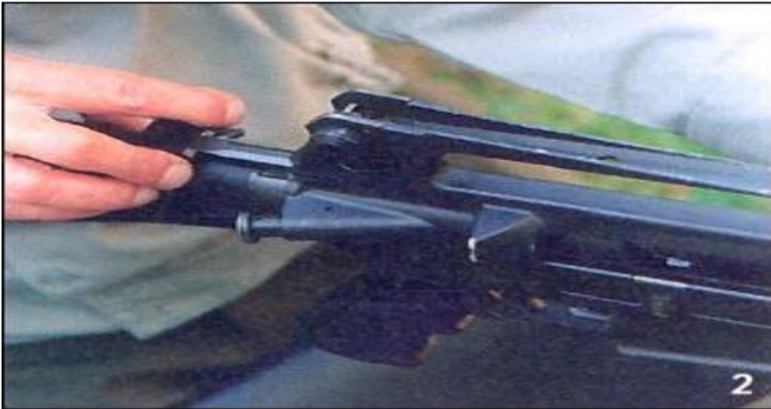
Рисунок 1.11 – Відведення назад планки перезарядження
