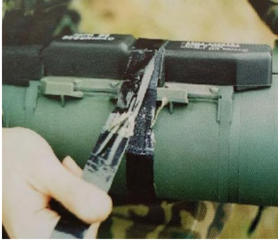
Рисунок 3.7 – Контрольна стрічка на захисній кришці спускового механізму
