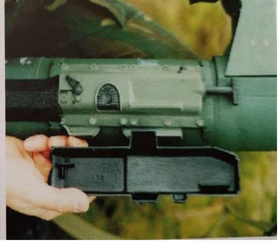
Рисунок 3.8 – Зняття захисної кришки спускового механізму
