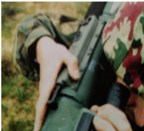
Рисунок 3.9 – Затискання кнопки безпеки важеля бойового взведення (кнопки “М”)
