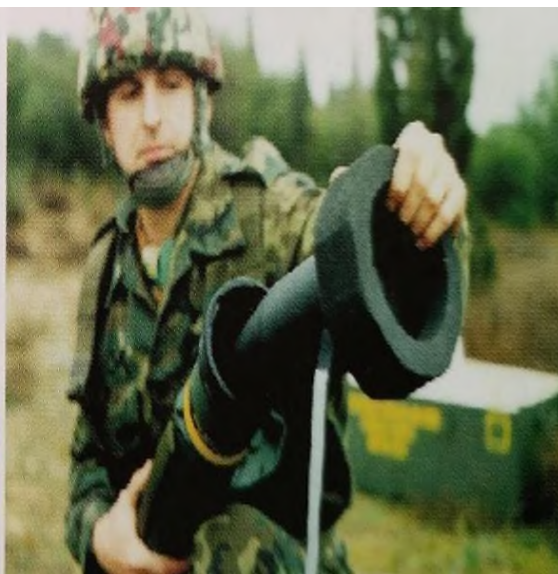
Рисунок 3.5 – Вилучення передньої захисної кришки
