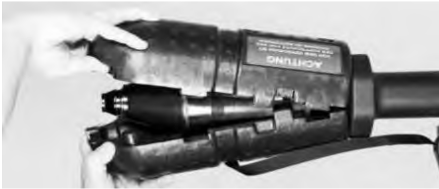
Рисунок 5.4 – Зняття кришки запальника та приєднання ініціатора
