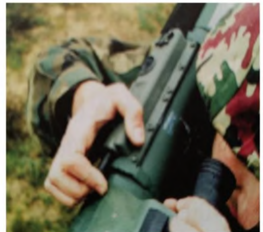
Рисунок 3.10 – Натискання важеля бойового взведення
