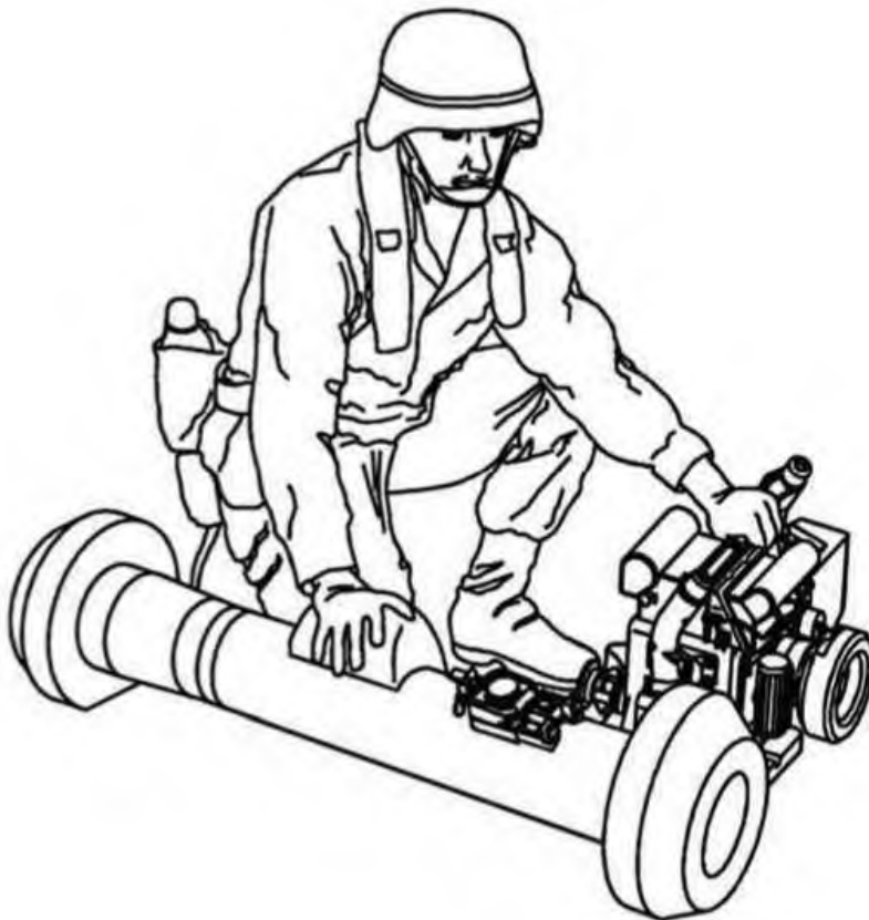
Рисунок 6.39 – Приєднання дисплею командного запуску CLU до Javeline
