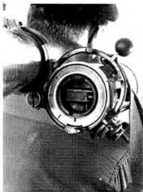
Рисунок 4.33 – Заряджання та встановлення підкаліберного пристрою
