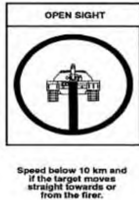
Рисунок 4.23 – Схема прицілу “Механічний приціл” – ціль назустріч/відхід
