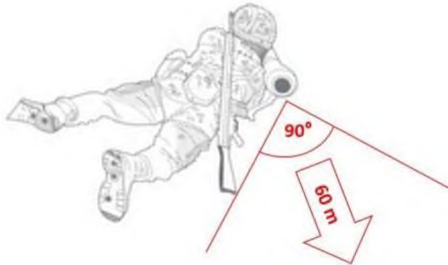
Рисунок 5.12 – Перевірка зони дії порохових газів
