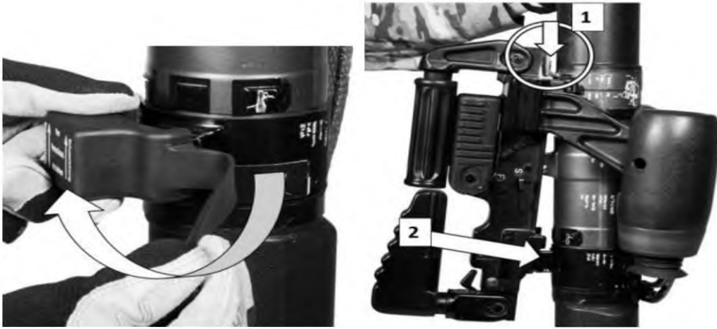
Рисунок 5.3 – Зняття кришки запальника та приєднання ініціатора
